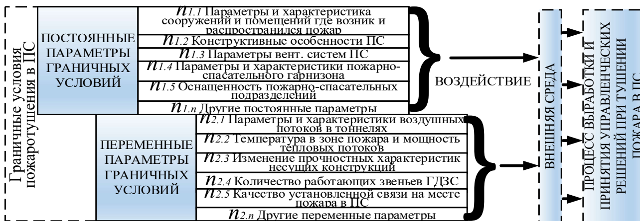
Рисунок 3 – Группы граничных условий при пожаре в ПС
